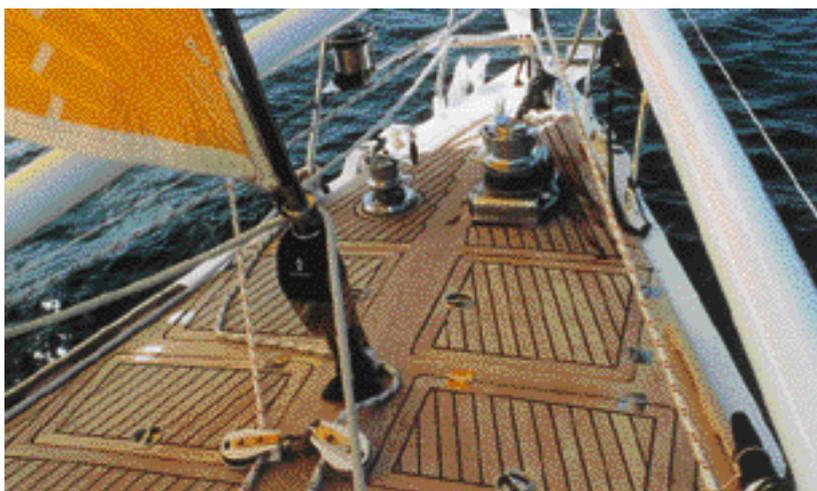
Pont de bateau en teck réalisé sur un chantier naval français, selon une technique d'assemblage des lames par un joint de polyuréthane.
