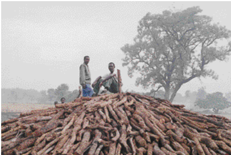
Photo 3. Meule de carbonisation pour la production du charbon de bois, au Mali. Carbonization grinder for producing charcoal, in Mali.
