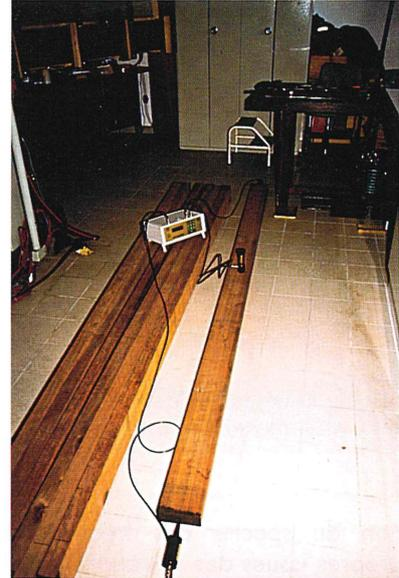
Mesure de la vitesse de propagation des ondes ultrasonores par l'appareil SYLVATEST.
