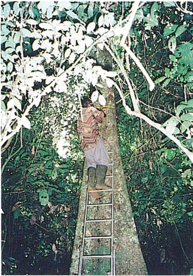
Mesure de diamètre sur un arbre avec contreforts.
