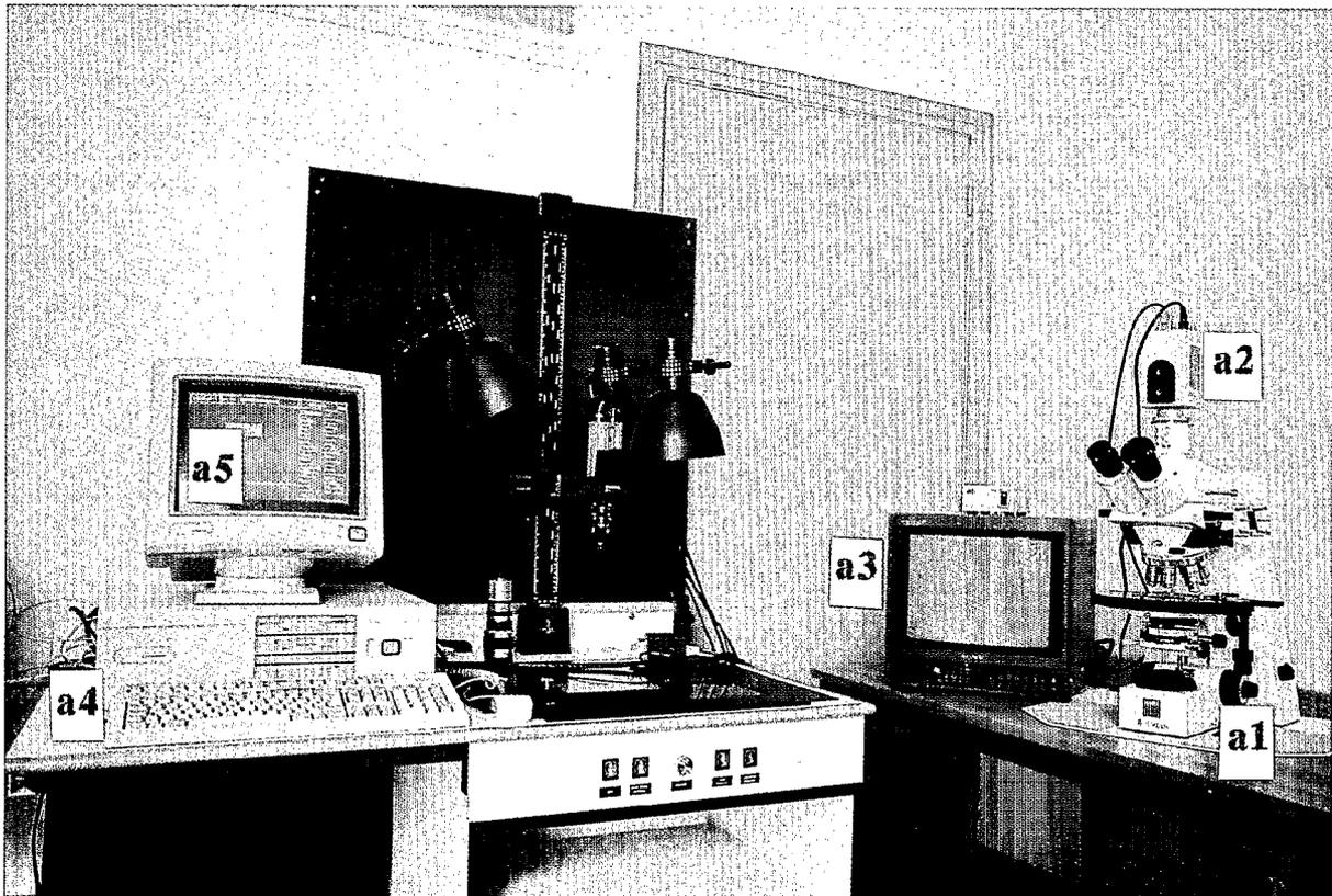
Système d'analyse d'image pour mesurer la densité des bois sur coupe microscopique.
