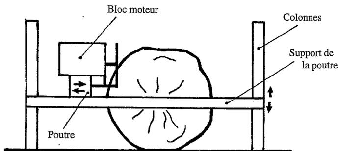
Schéma d'une scie circulaire pour le sciage dans la masse.
