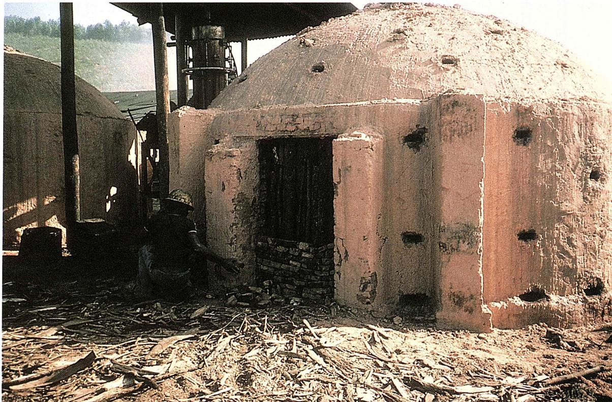
Fours de carbonisation maçonnés au Brésil
