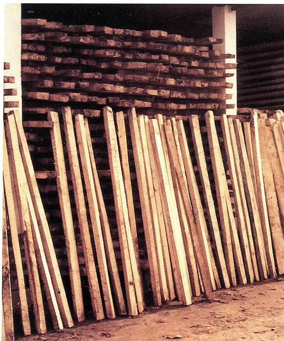
Photo du haut : sciage des bois de première éclaircie ; ci-dessous : chevrons de 2 m, produit de première éclaircie dans les parcelles de pins.
