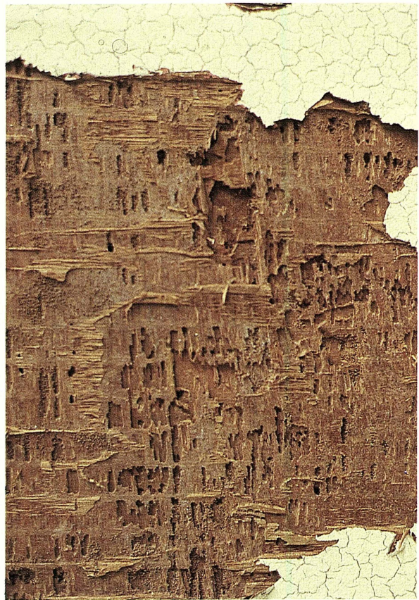
Dégâts de Cryptotermes brevis dans des bois œuvrés.
