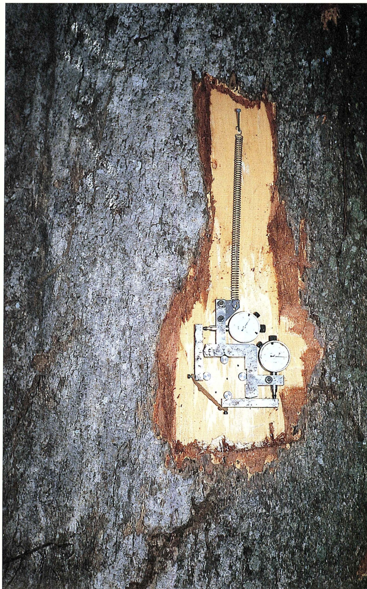
PHOTO 3. — Capteur destiné à la mesure du niveau de « contraintes de croissance ». (Photo C. SALES).
