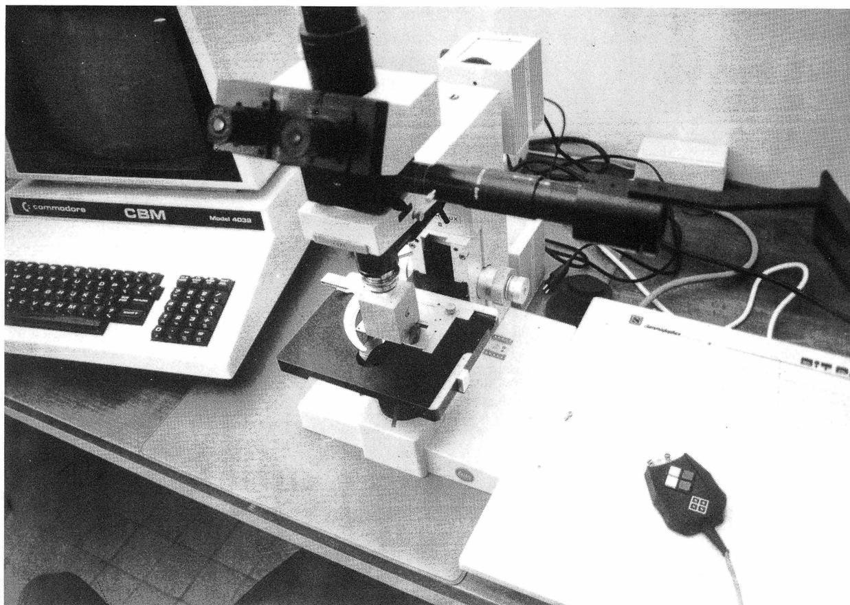
FIG. 1. — Vue du microscope avec dispositif d'analyse semi-automatique d'image.
