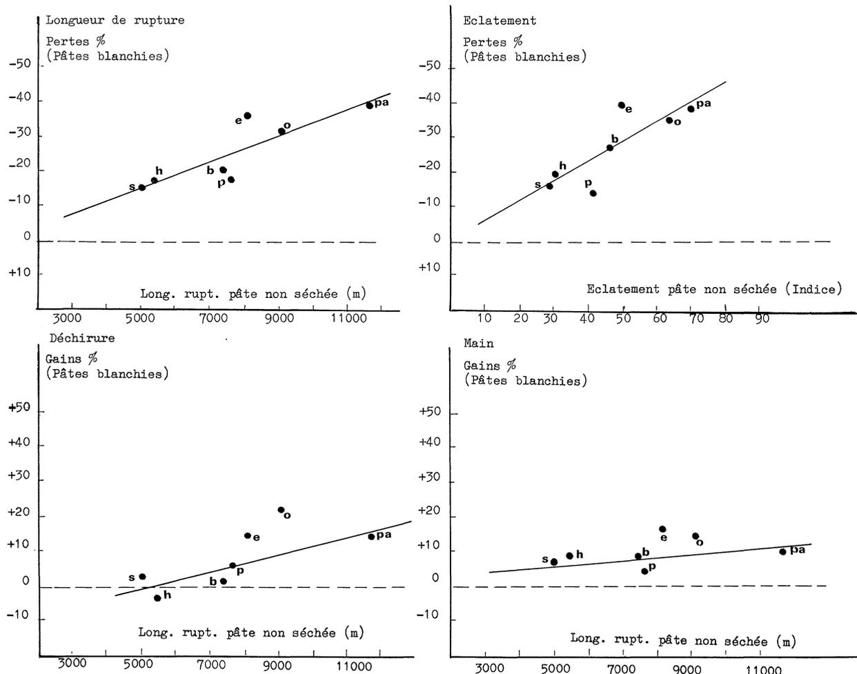
FIG. 3. — Influence du séchage des pâtes cellulósiques sur les caractéristiques des papiers :  $\frac{I. \text{ sec} - I. \text{ non sec}}{I. \text{ non sec}} \%$ .
