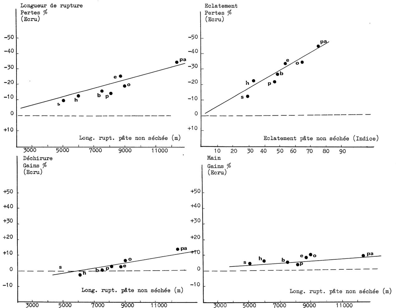
FIG. 2. — Influence du séchage des pâtes cellulósiques sur les caractéristiques des papiers :  $\frac{I. \text{ sec} - I. \text{ non sec}}{I. \text{ non sec}}$ .
