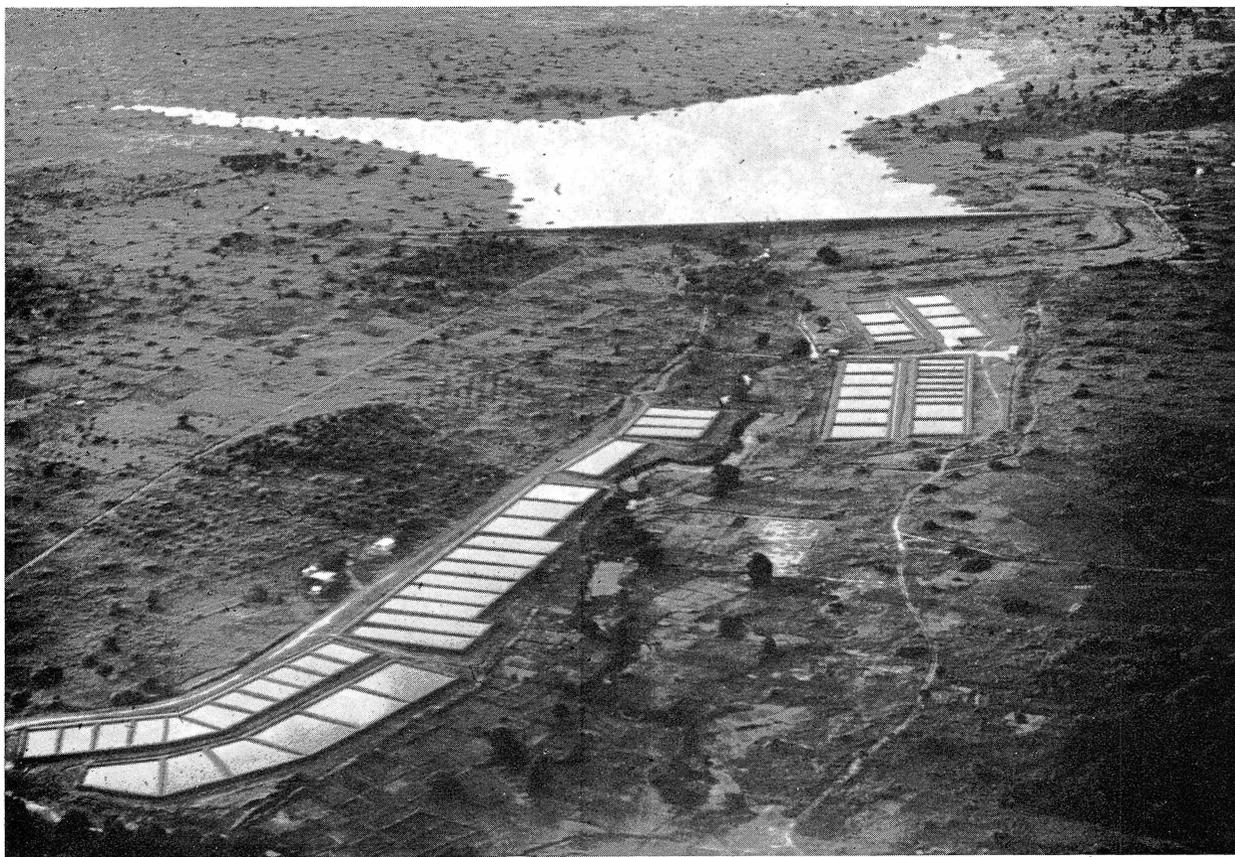
*Vue aérienne de la ferme piscicole pilote de Natio-Kobadara (Korhogo, Côte-d'Ivoire). A gauche, les étangs alimentés en eau par gravité, à droite, les étangs alimentés par pompage ; en arrière-plan, le lac de retenue du barrage de Natio-Kobadara.*
