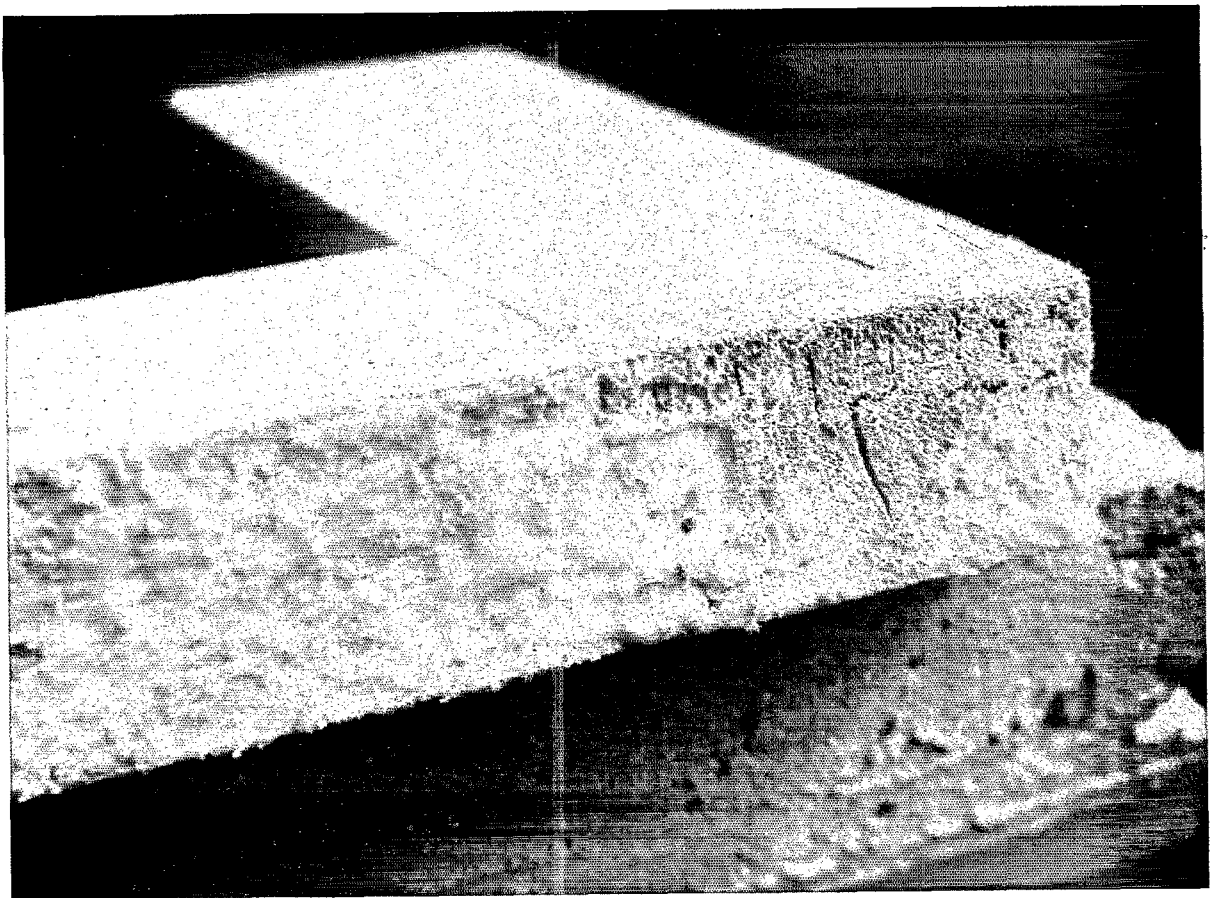
Fig. 6. — Développement mycélien de Gloeophyllum trabeum à la base d'une éprouvette.
