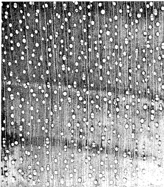
FIG. 9. — Section transversale d' Aucoumea klaineana à faible grossissement ( \times 10 ), montrant des cernes d'accroissement.
