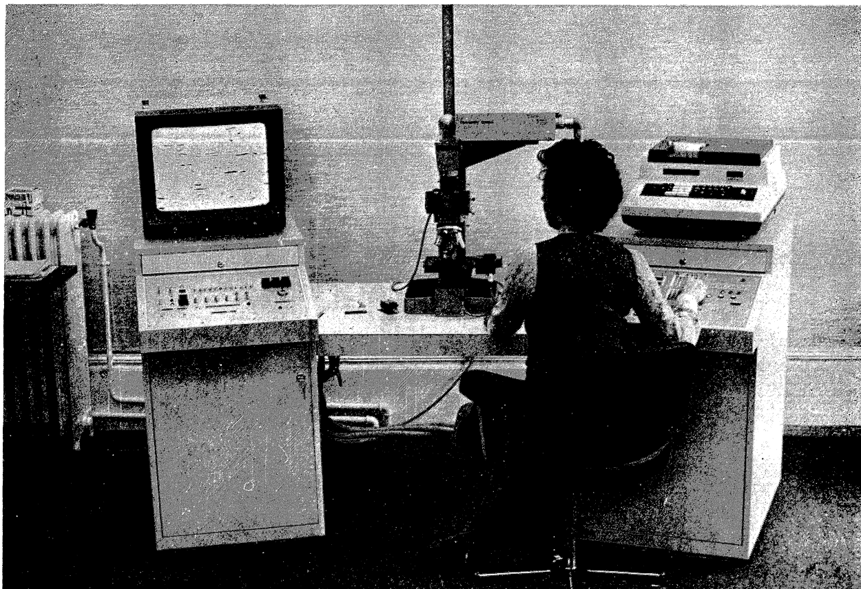
Vue générale de l'analyseur de texture.
