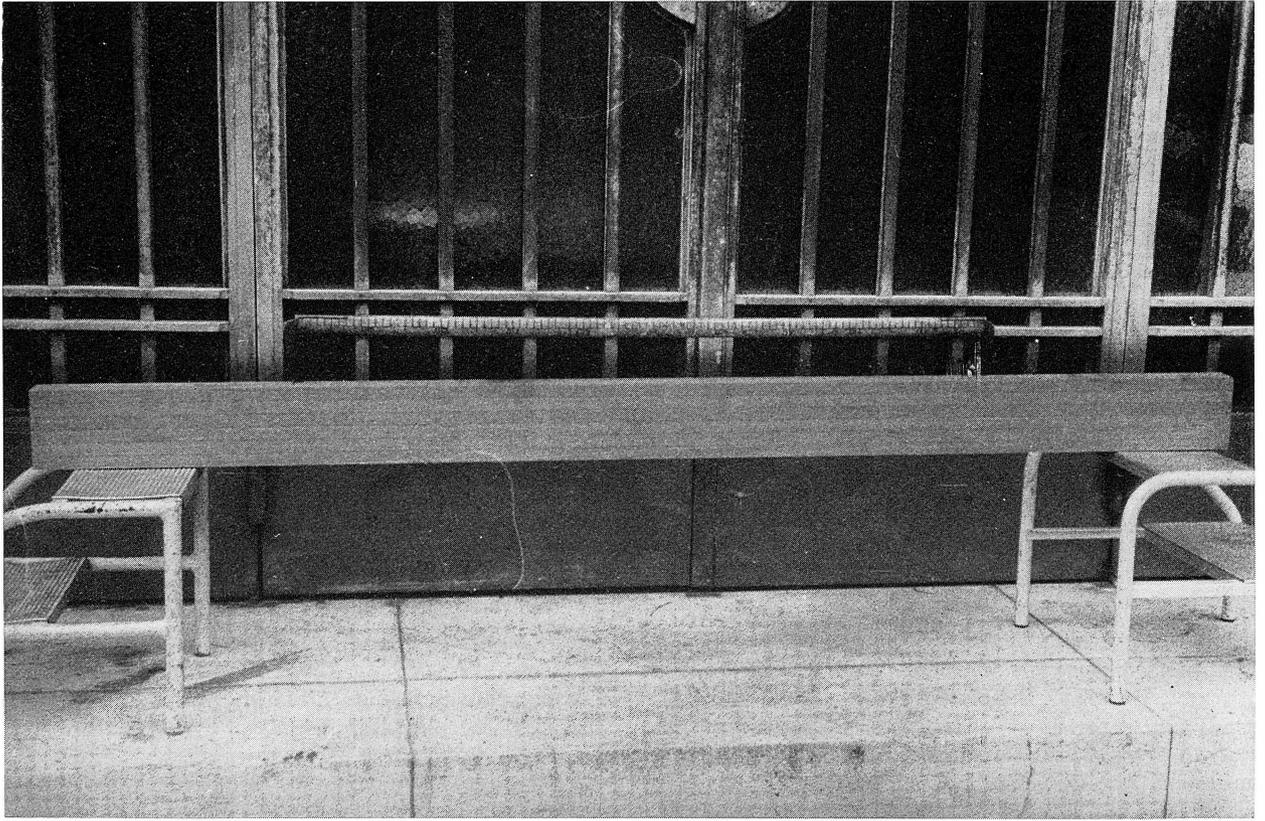
*Poutre lamellée-collée en Movingui avant essai de rupture en flexion.*
