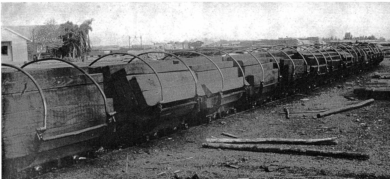
Afrique du sud — Chargement de traverses incisées à leur sortie de l'autoclave de créosotage
