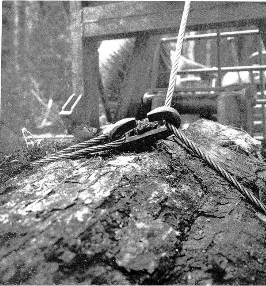
« C » en acier octogone utilisé à la place d'un crochet.
