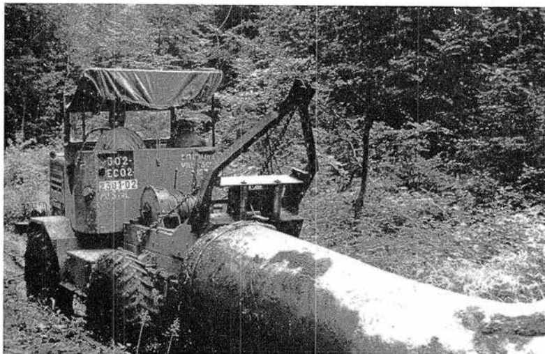
LDU Labourier tirant une grume de hêtre.
