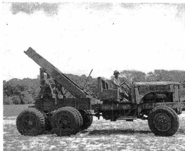
Diamond 6x6 équipé pour le débardage.
