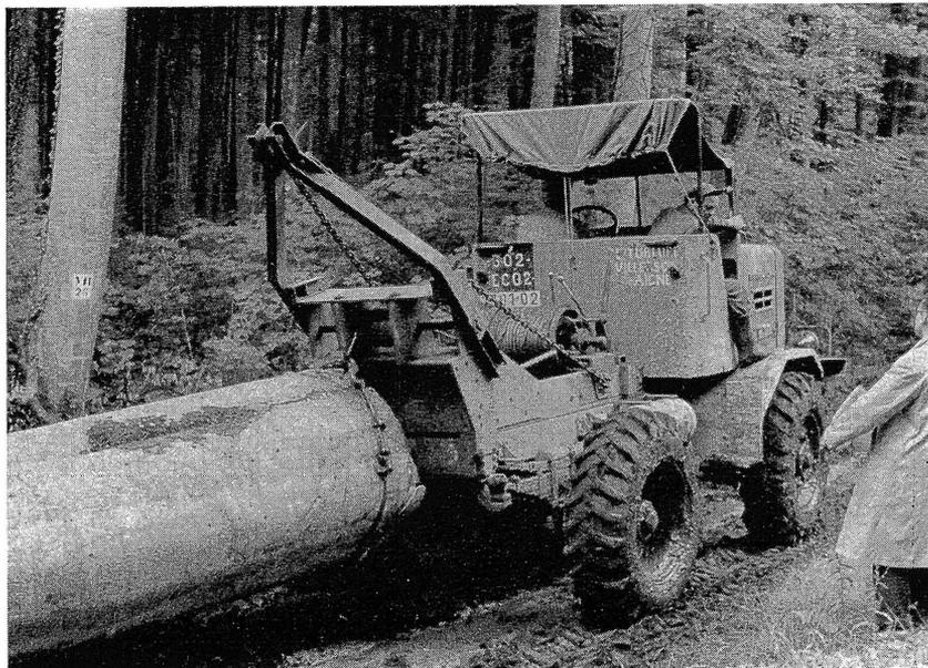
*Pneu type "Dumper" sur labourier LDU.*
