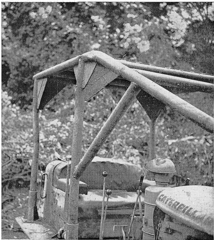
Cabine S. C. A. F. Détail des renforcements du toit.
