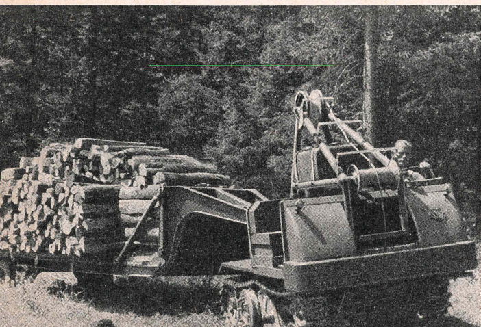
Tracteur autrichien « Automule » d'un principe nouveau : il est semi-porteur
