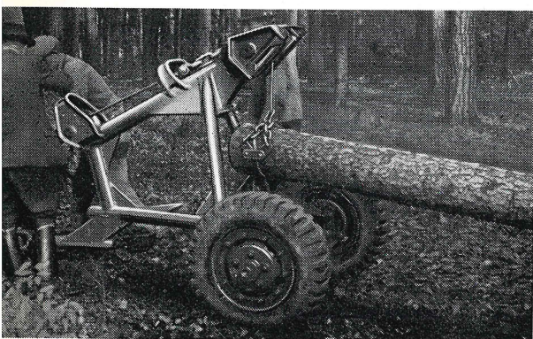
Arche à roues pour être remorquée par le Fiat « 601 » pour débardage léger
