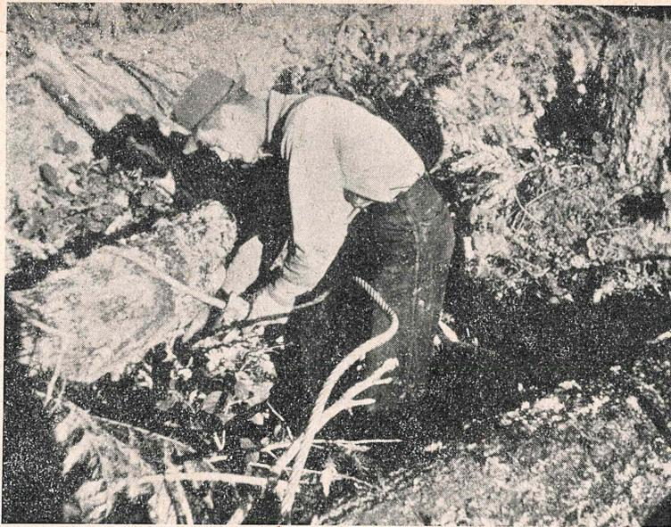
PHOTO N° 3. — Fixation du « choker » autour d'une grume.
