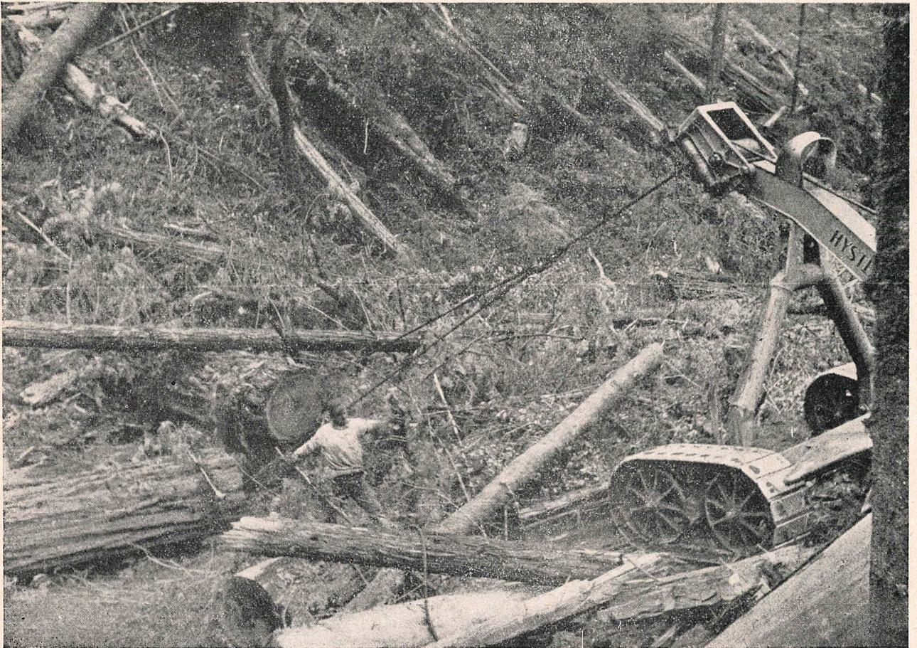
PHOTO N° 4. — Arche approchant deux grumes (à la droite de l'ouvrier on distingue un « choker » au travail).
