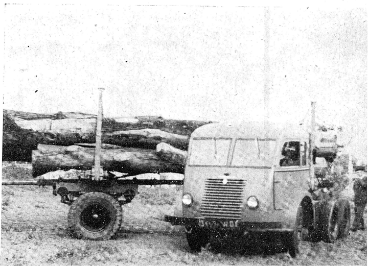
La sellette d'accrochage articulée permet une grande maniabilité de l'ensemble grumier
