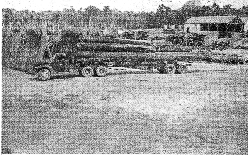
Photo Madeira del Trop Transport de billes longues sur train grumier de 20 tonnes
