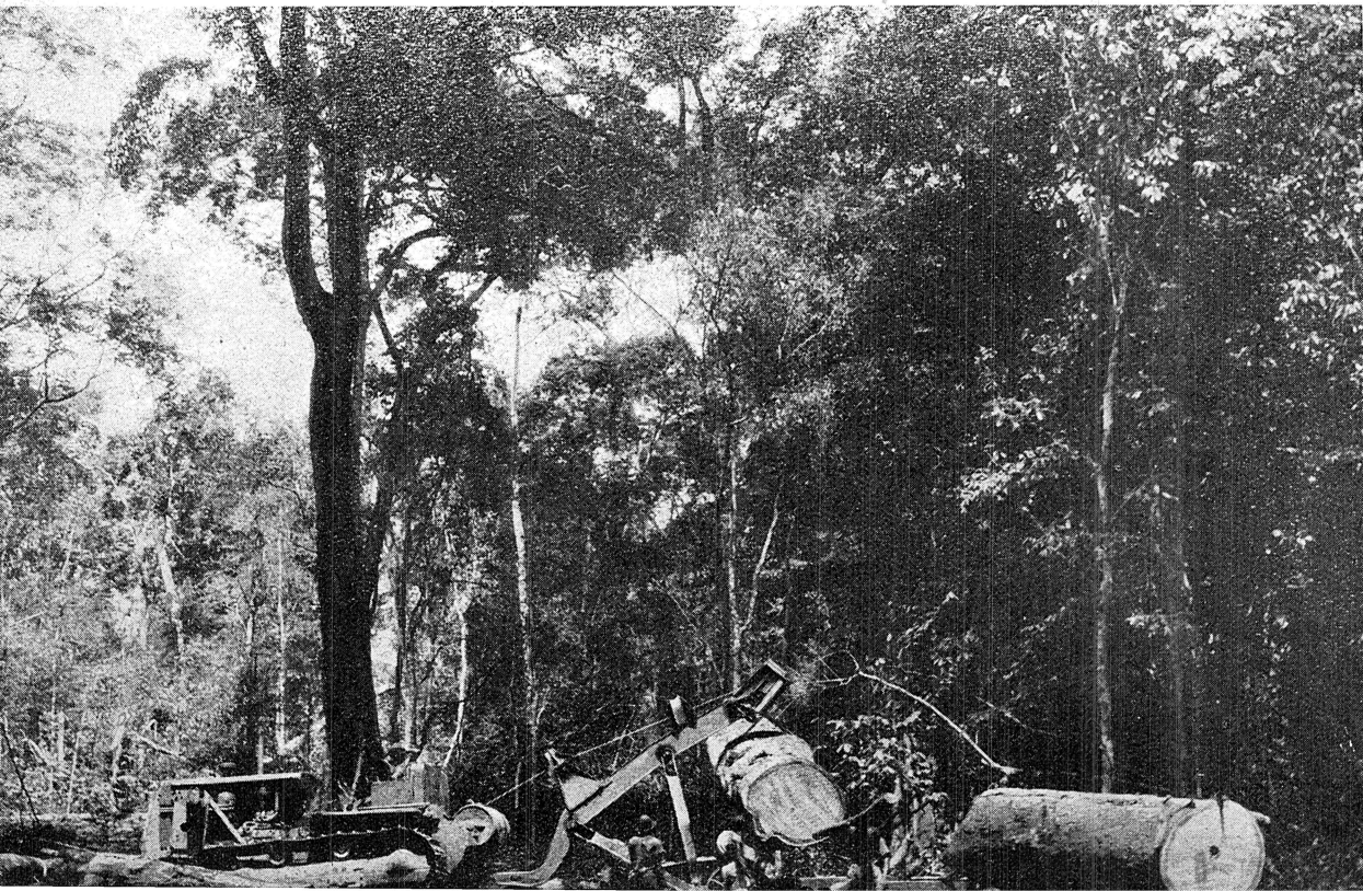
Levage et chargement d'une grume sur wagonnet au moyen d'un tracteur et de son treuil (Gabon)
