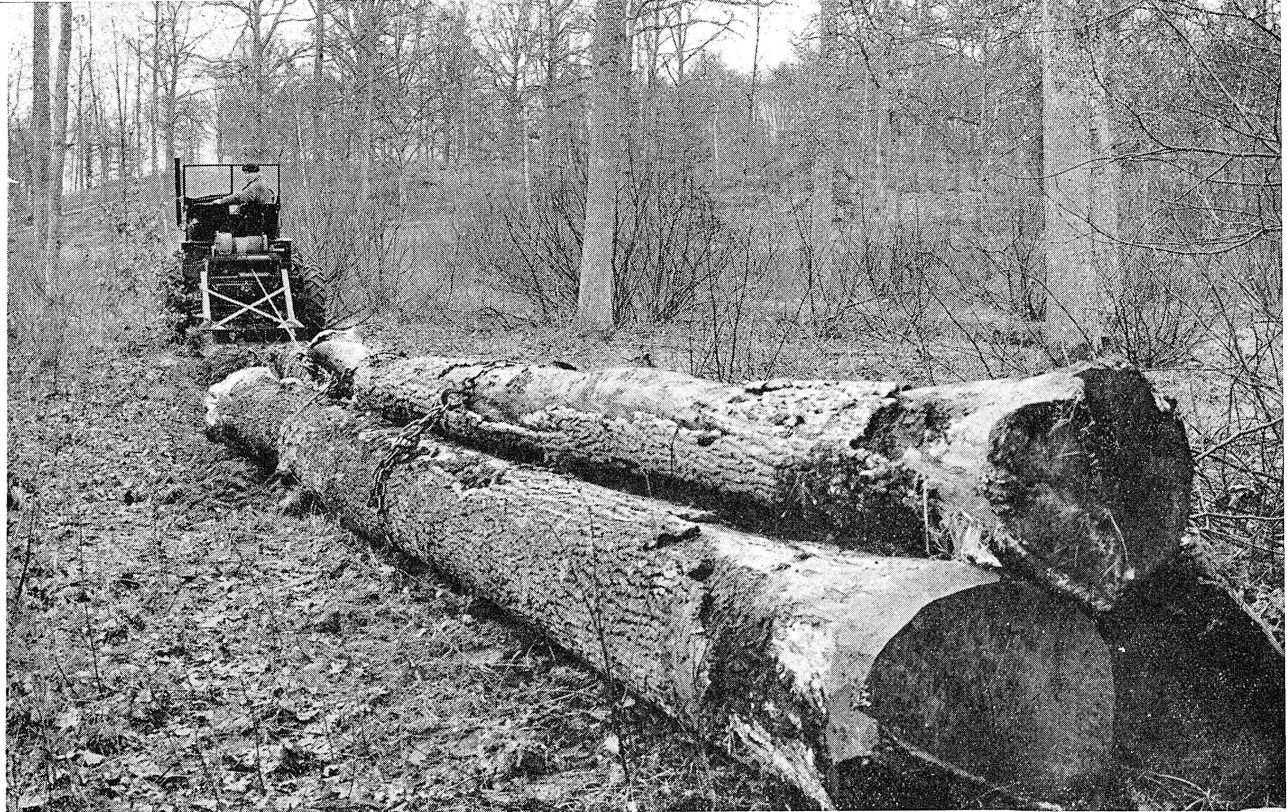
Halage à froid par treuil à bêche monté sur LATIL 65 HP.
