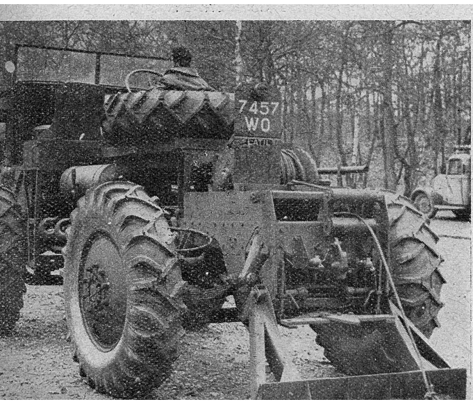
Le nouveau Latil 120 HP équipé en tracteur, avec son treuil et sa bêche d'ancrage
