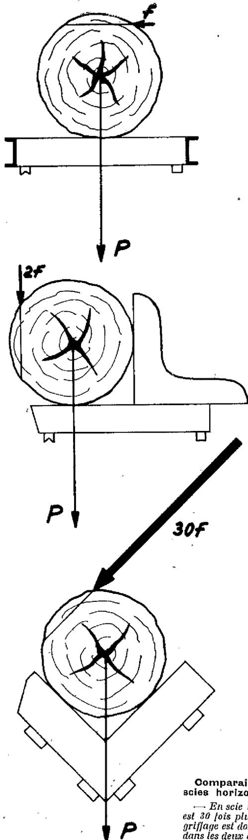
Elle est excellente également dans les scies verticales quand après enlèvement d'une dose la face plane de la bille est posée sur les glissières à condition que le griffage soit énergique. La stabilité est par contre moins bonne et même souvent médiocre quand la bille ne repose pas sur une face plane préalablement usinée.
